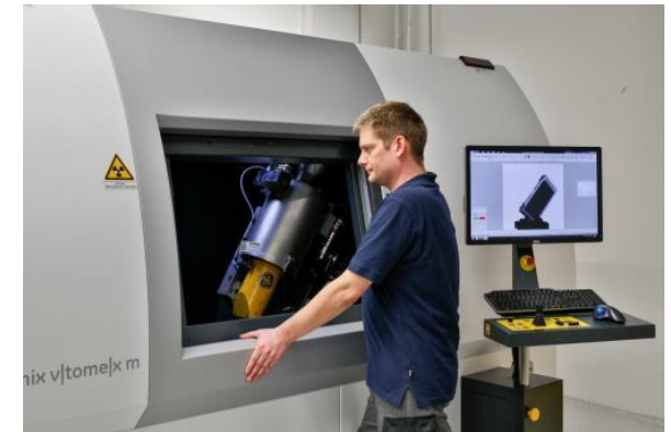
Schadensanalyse mit 3D-Computertomograph
